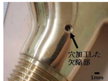
図 1 深い欠陥を有する CAC406 製水栓製品
