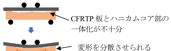
図 14 コの字型 CFRTP を用いたハニカム試験片のイメージ
