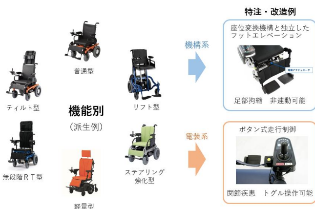
図1 電動車椅子の種類と特注・改造の一例
