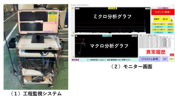
図2 工程監視システムの外観およびモニター画面
