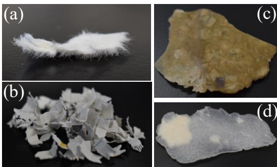
図 1 ドライパルプシート(a)、ペーパーシュレッターダスト(b)、ドライパルプシートと PP の混練物(c)、ペーパーシュレッターダストと PP の混練物(d)の画像
