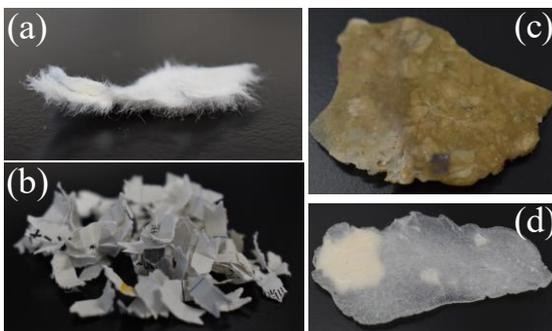
図 1 ドライパルプシート(a)、ペーパーシュレッターダスト(b)、ドライパルプシートと PP の混練物(c)、ペーパーシュレッターダストと PP の混練物の画像
