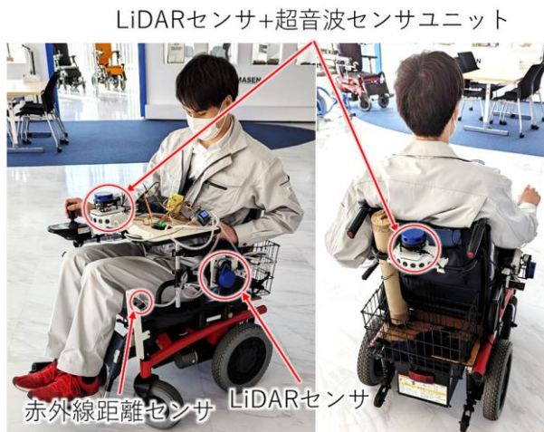
図9 電動車いすに安全装置を搭載した様子
