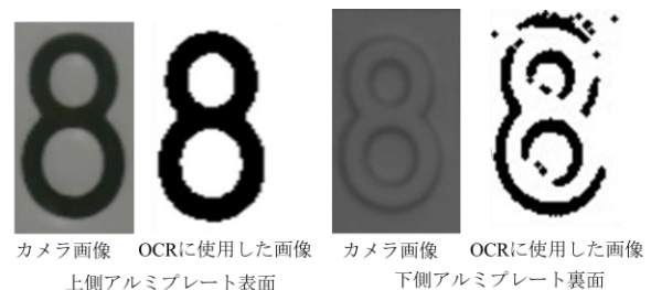
図2 カメラ画像とOCRに使用した画像の例
