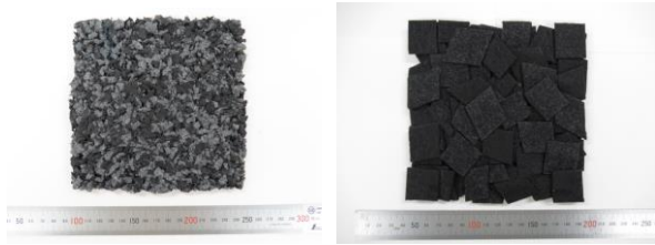
破砕片 100% カット片 100% 図1 端材分解片から試作したボード
