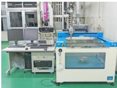
図3 超音波探傷装置
