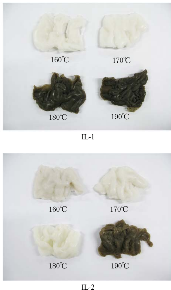
図 2 160℃～190℃で混練したイオン液体 1 wt%混練物
