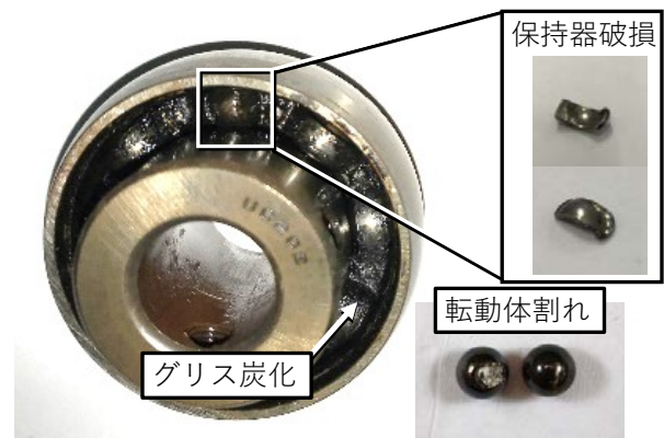
写真2 試験2実施後の分解調査結果（軸受破損）
