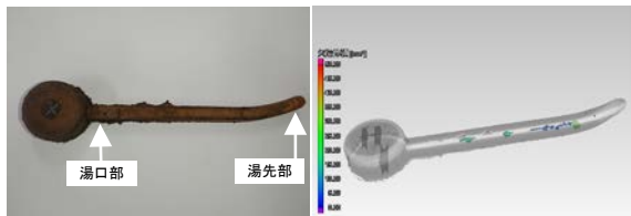
図2 铸造した青铜铸件（左）とCT像（右）
