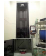
図2 落錘衝撃試験機
