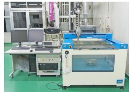
図3 超音波探傷装置
