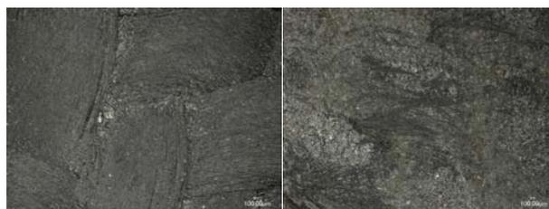
(a) CF/PA6 破断面、×50 (b) A5052(BT)破断面、×50
