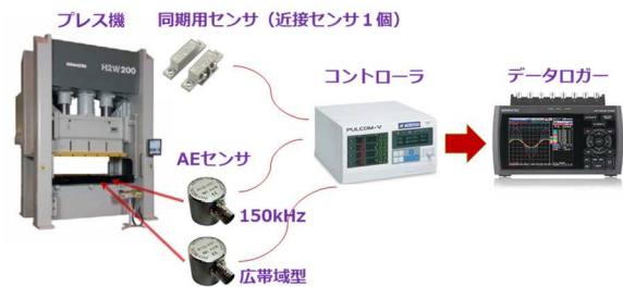
図1 システムの概略図
