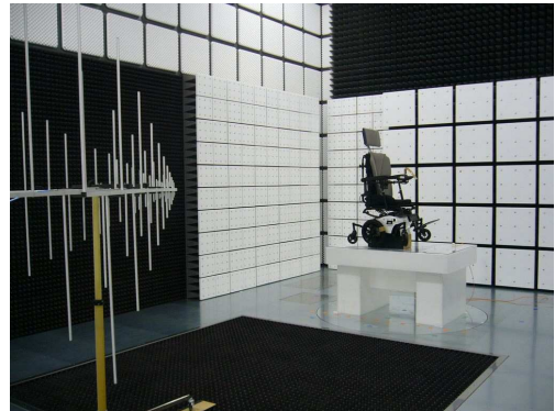
図1 電動車いすの放射免疫試験
