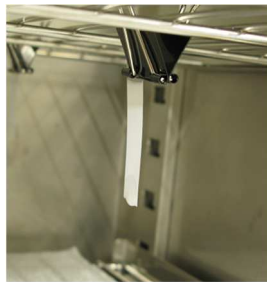
図 2 コーティングした PP シートの乾燥方
