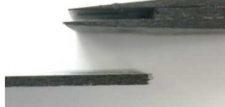
図1 チャック部付近での破断
