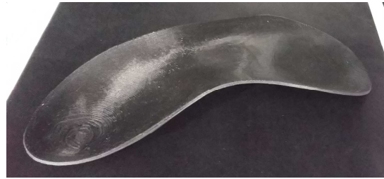
図3 試作したCFRTP製インソール
