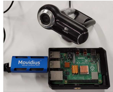
図1 監視システムの機器構成
