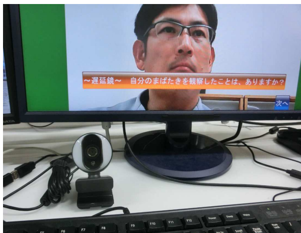
図2 USBカメラと遅延鏡表示
