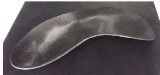
図3 試作したCFRTPL製インソール
