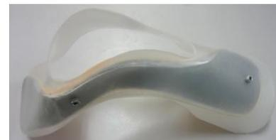
図5 CFRTP補強材を適用した試作
