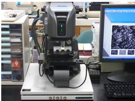
図3 レーザー顕微鏡システム
