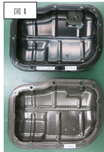
図1 670gの金属製オイルパン（上）と240gのCFRTP製オイルパン（下）（県内企業との共同開発品）
