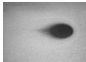
図7 燃焼後サンプル(窒素リン系難燃剤を含浸)
