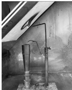
図 1 メッセルバーナーによる燃焼試験
