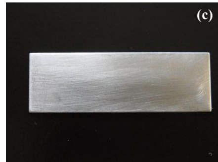
図5 室温 25°C、相対湿度 97%RH に 2 日静置した各基板の外観画像 (a)未処理、(b)PFDPA 処理、(c)UDPA 処理
