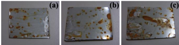
図4 塩水噴霧試験における各基板の外観変化 (a)未処理、(b)PFDPA 処理、(c)UDPA 処理
