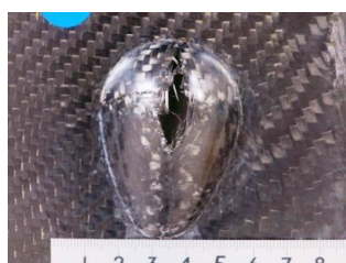
図8 CFRP織物平板の卵型立体成形品
