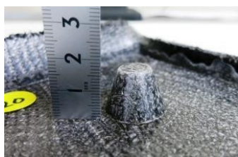
図9 CFRPニット平板の凸型立体成形品
