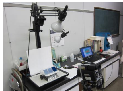
図10 フィルムの表面温度測定の外観
