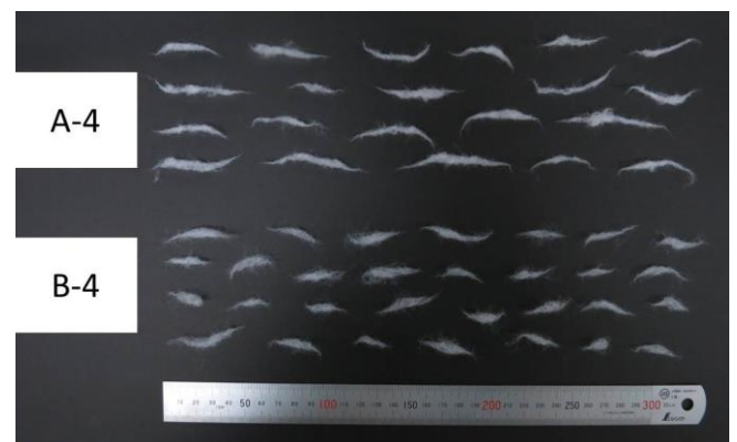
図7 条件Bの変更に伴うわた形状の変化
