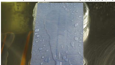
図8 ラインタイプ(コロナ処理無)の水展開及び水跳ね性
