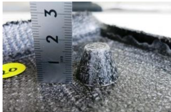
図9 CFRPニット平板の凸型立体成形品
