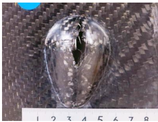
図8 CFRP織物平板の卵型立体成形品
