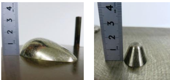
図2 立体成形金型(左:卵型、右:凸型)
