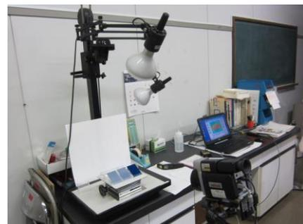
図10 フィルムの表面温度測定の外観
