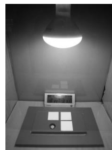
図1 赤外線ランプ照射による評価装置
