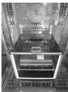
図 3 恒温恒湿機内にデシケーターを設置した評価装置
