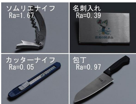
図15 ステンレス製品へのマーキング
