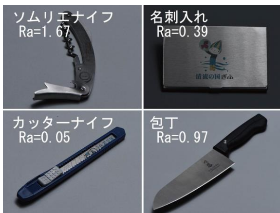
図15 ステンレス製品へのマーキング
