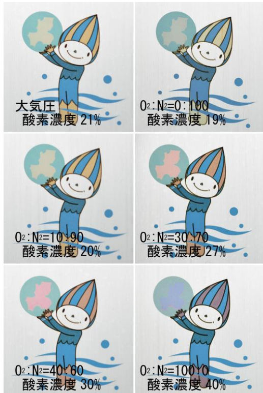
図14 アシストガスを付与したマーキング
