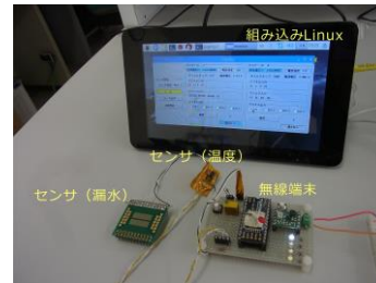
図6 センサ無線端末とデータをモニタする組み込み Linux
