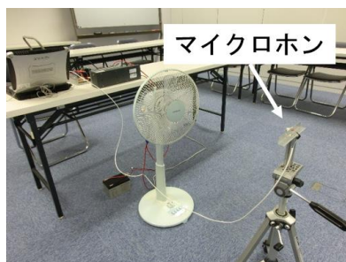
図1 扇風機の風測定
