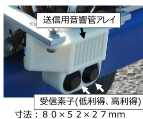
(a) 超音波PAソナーのセンサーヘッド
