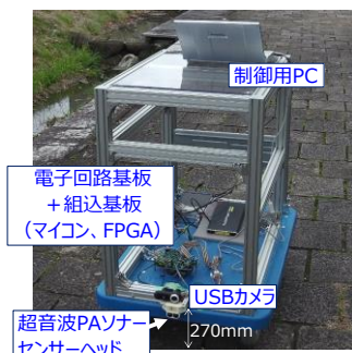
(b) 実験用台車への実装 図3 開発した検証用システム
