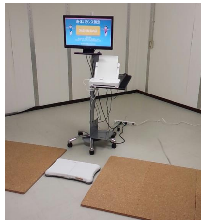
図3 自立式床反力情報取得・解析システム
