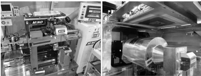
図6. スクリーンオフセット印刷機
