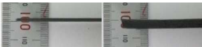
図8 CFRTP板の厚みの変化(左:加熱前、右:加熱後)
