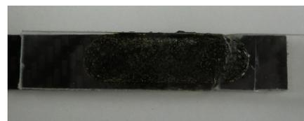
図8 レーザ溶着試験片(条件2)
