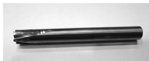
図2 試作した切削工具の外観 ( \phi 12\text{mm} )
