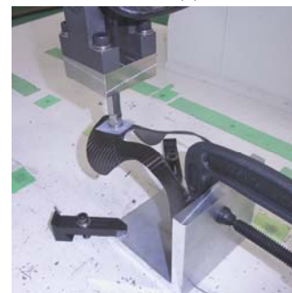
図2 強度試験の様子（変位45mm,荷重約400N時）
