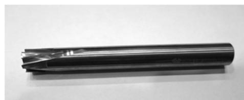
図2 試作した切削工具の外観 ( $\phi 12\text{mm}$ )
