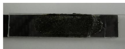
図8 レーザ溶着試験片(条件2)
