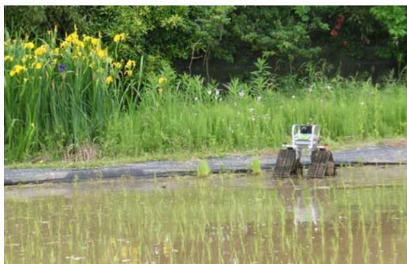
図1 水田用小型除草ロボット『アイガモロボット』
