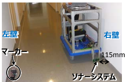
図8 廊下走行検証実験の様子
