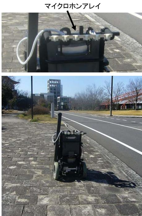
図2 電動車いす走行音の実験
