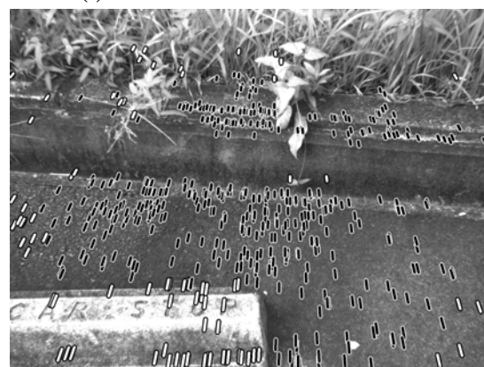
(b) 識別結果（黒線：平面、白線：障害物）
