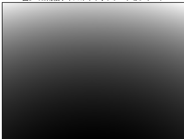
図6 キャリブレーションで求めたカメラからの距離 Z (輝度値が明るくなるに従い、距離 Z の値は大きくなる)
