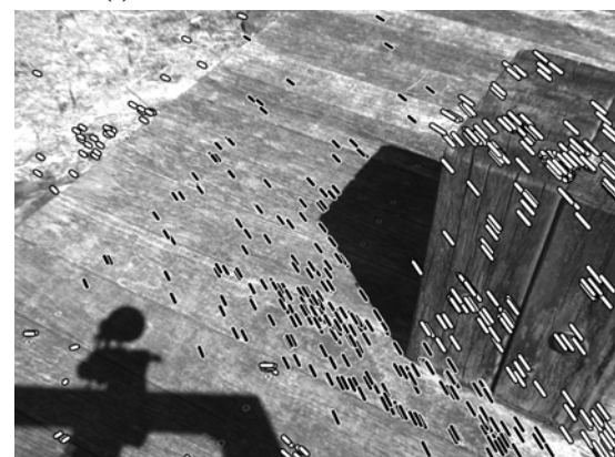
(b) 識別結果（黒線：平面，白線：障害物）
