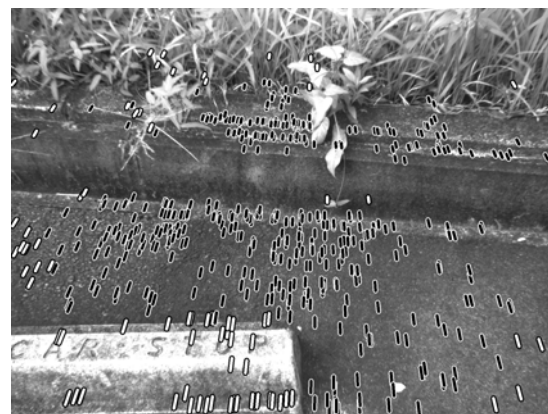
(b) 識別結果（黒線：平面、白線：障害物）
