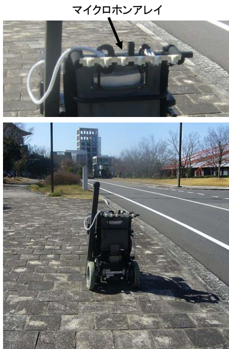
図2 電動車いす走行音の実験
