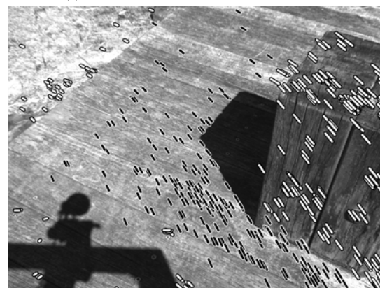
(b) 識別結果（黒線：平面、白線：障害物）
