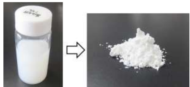
図2 CeNFと無機ファイラーの混合溶液とスプレードライ後の複合粉体
