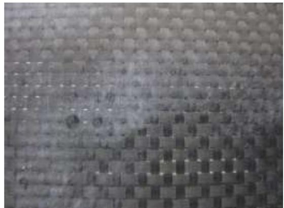
図1 220℃、5MPa、15分間大気圧プレスを行ったときの外観
