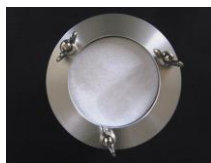
図 2 カップ法による測定サンプル外観(左)
