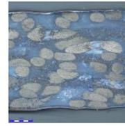
図12 CF ニット 4ply+CF シート 3ply(3mm, 50g/m<sup>2</sup>)
