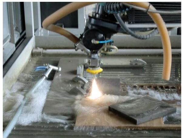
図1 チタン切断の様子
