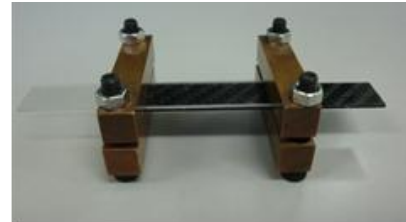
図6 レーザ溶着用圧着治具
