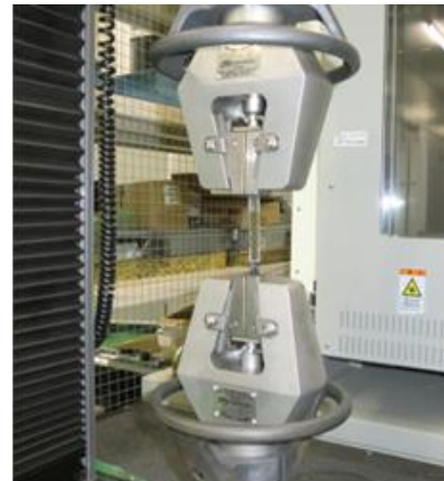
図7 レーザ溶着試験片の引張試験
