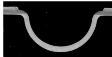
図10 成形品 (予備加熱温度:240℃、プレス速度:10mm/s、金型温度:80℃) の X 線 CT 像
