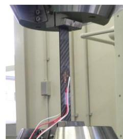
図1 歪ゲージを貼り付けてチャックした試験片
