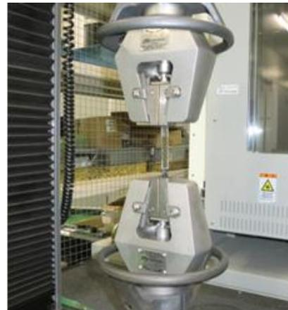
図7 レーザ溶着試験片の引張試験
