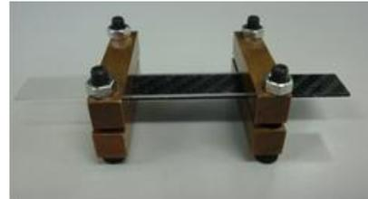
図6 レーザ溶着用圧着治具
