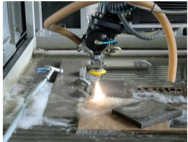
図1 チタン切断の様子
