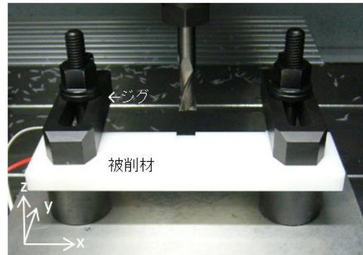
図2 被削材とジグからなる機械構造物
