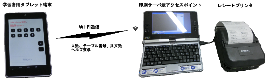
図2 喫茶サービス学習用印刷サービスシステム
